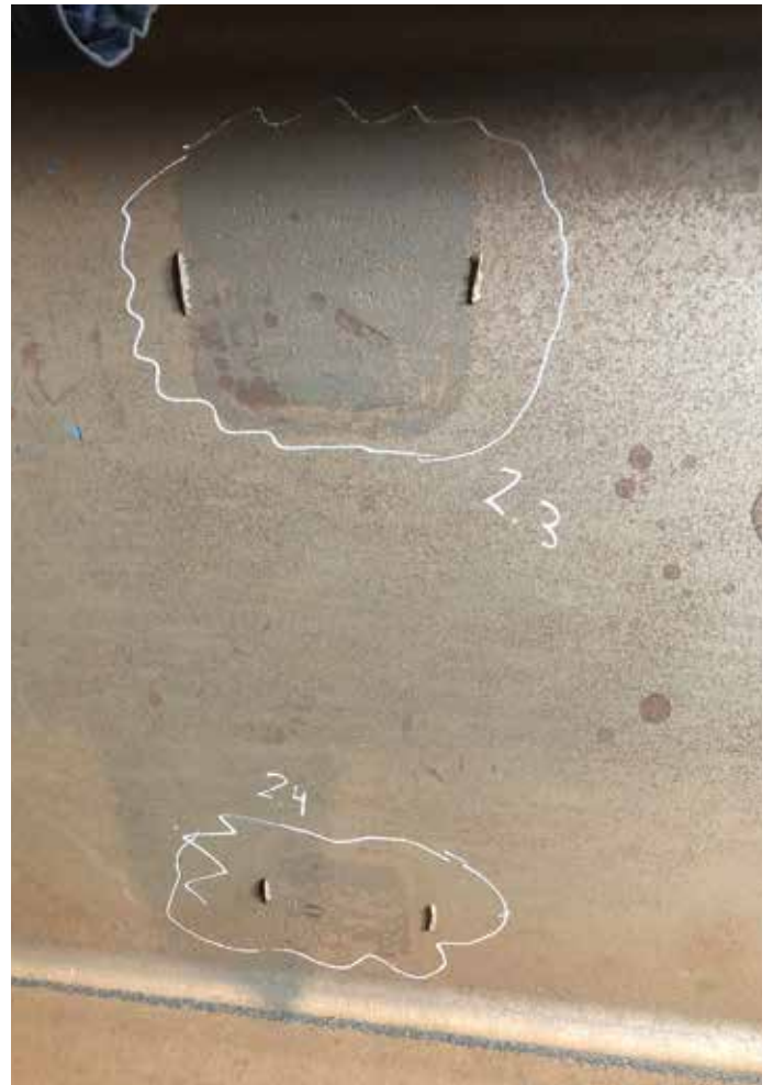
Monsters circulaire liggers voor materiaalonderzoek, ingekochte HEB 900-liggers en kettingglassen op liggers die microscheuren hebben veroorzaakt.
