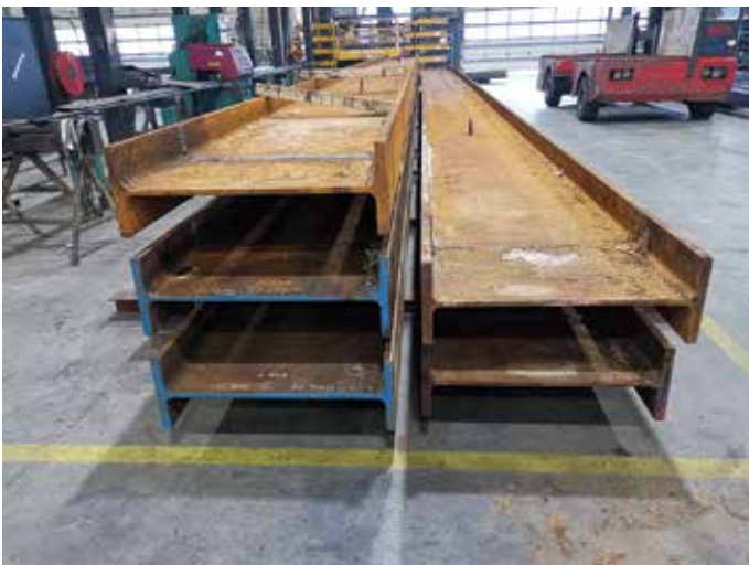
Monsters circulaire liggers voor materiaalonderzoek, ingekochte HEB 900-liggers en kettingglassen op liggers die microscheuren hebben veroorzaakt.
