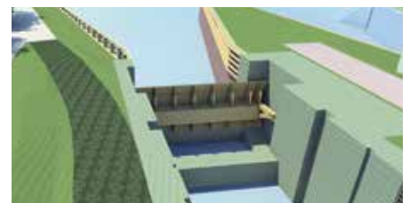
Segmentdeur in het bovenhoofd van nieuwe sluisolk.
