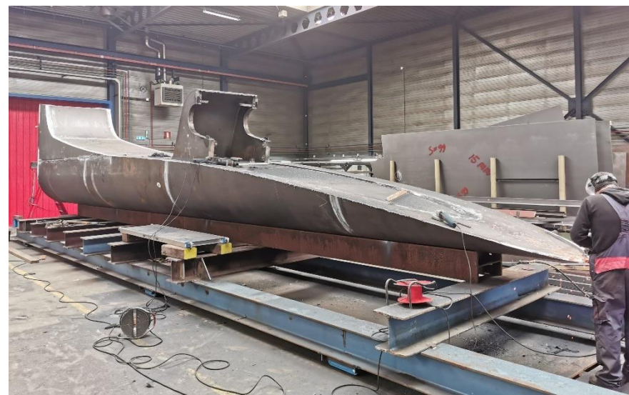
Fabricage hameistijl in de fabriek van KnookStaal B.V.
