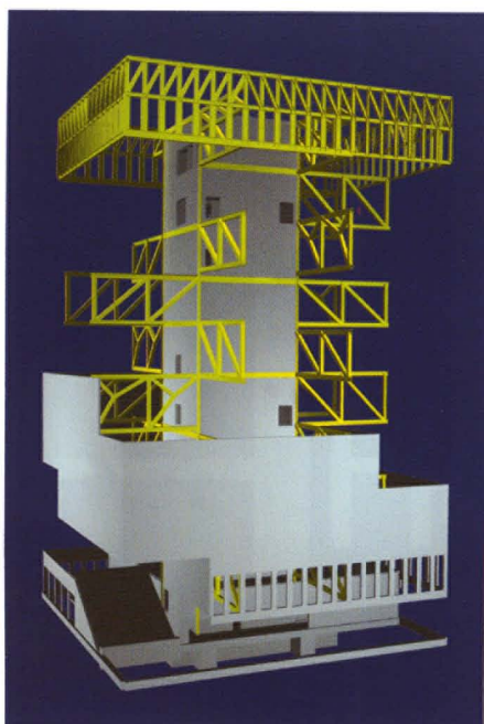
1. Het skelet van de toren. In de gele verticale lijnen op de hoeken van de kern zijn stalen spreadstukken verwerkt voor de inleiding van samenkomende trek- en drukkrachten uit de spanten (afb. 9).
