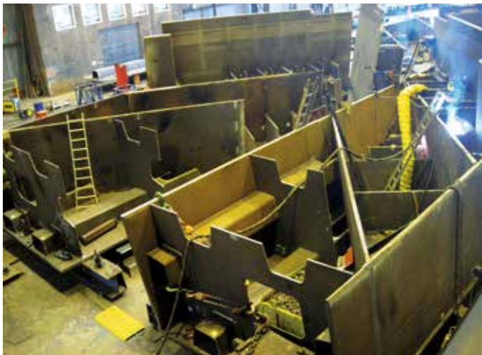
Assemblage booggeboorte in productiewerkplaats.
