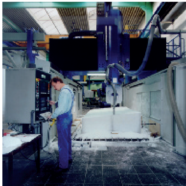
11 | Wandbekisting met tussenlaag uit kunststof (links) en fabricage van de vormlaag met CNC-machine (rechts). Neue Zollhoff, Dusseldorf, architect Frank O. Gehry (Peri bekistingen)
