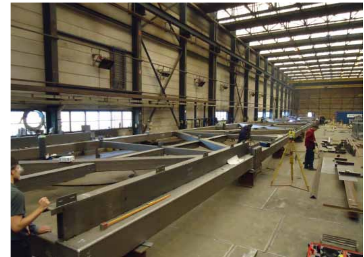
Het aantal lasverbindingen op het werk is geminimaliseerd. Deze zijn in de fabriek voorbereid en in lasten uitgevoerd.
