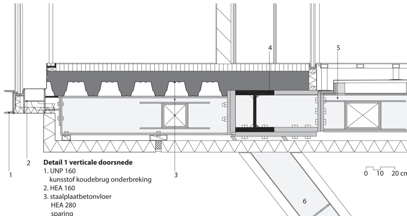
Detail 1 verticale doorsnede
