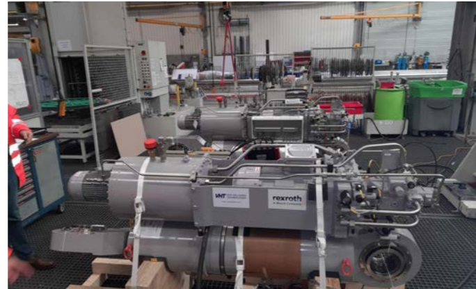
Hier zijn de twee EHA's (Electo-Hydraulische Aandrijvingen) te zien van Bosch Rexroth tijdens de FAT (Factory Acceptance Test). Deze hydraulische cilinders hebben hun eigen powerpack die op de rug van de cilinder gemonteerd zijn en daardoor grotendeels onderhoudsvrij. Na installatie zullen dus enkel stroomkabels naar de cilinders lopen en geen hydraulische slangen die met regelmaat vervangen zouden moeten worden.
