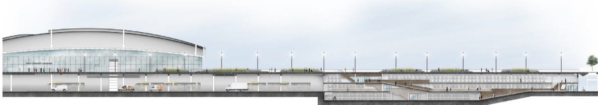
De doorsnede van het platform bij de Knopstalling maakt goed zichtbaar hoe de balustrade lokaal in hoogte verloopt.
