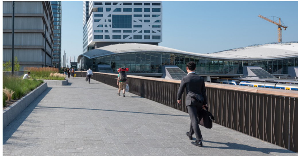
De balustrade is opgebouwd uit individuele stalen lamellen die om en om van elkaar verschillen.
