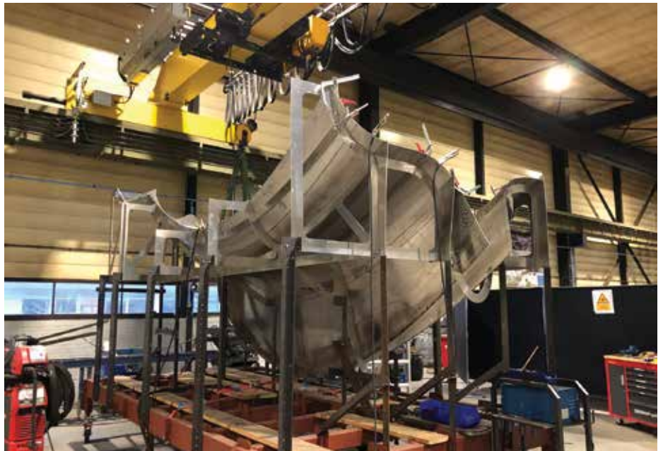
In speciale mallen worden de segmenten afgemonteerd.
