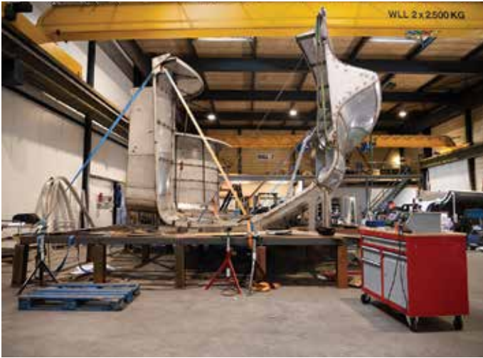
De platen zijn gevormd met persen zoals bij huidplaten voor de scheepsbouw.
