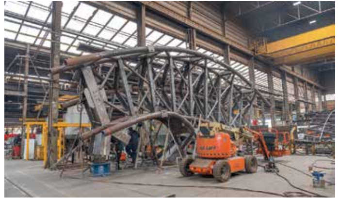
Secties worden na de productieaanleg ontkoppeld en omgekeerd voor bovenhands aflassen.
