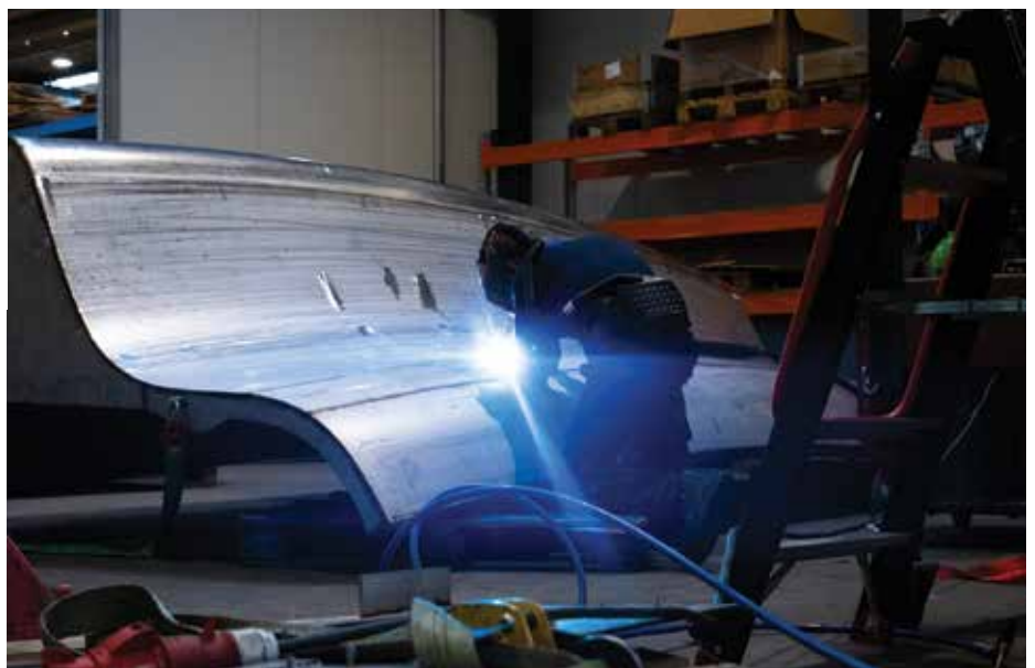
In speciale mallen worden de segmenten afgemonteerd.
