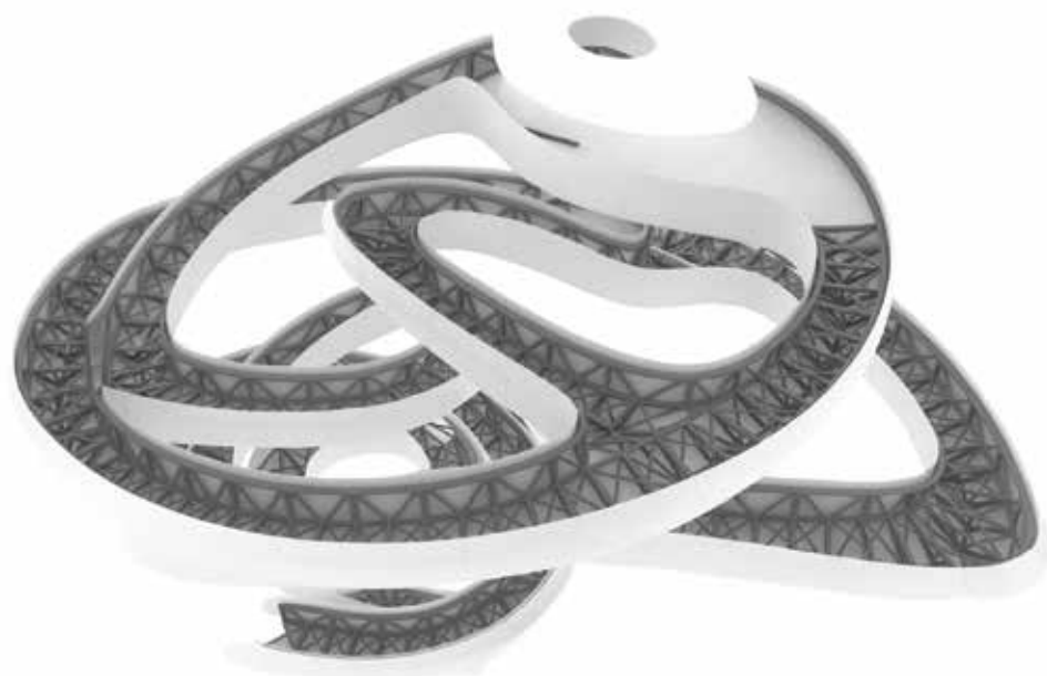
Totaaloverzicht staalconstructie en roestvast stalen huid met rechts de grootste uitkraging.
