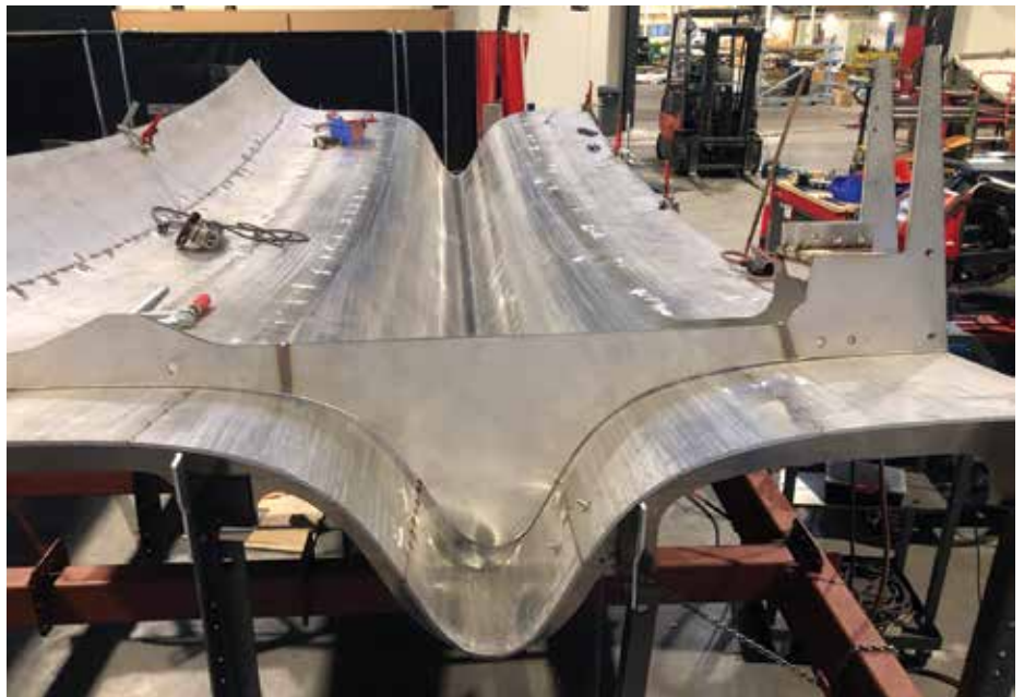
Voormontage van verstijvers op een side skirt (uitstulping).
