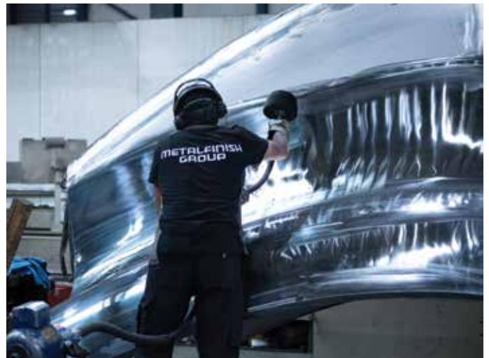
Laatste fabricagefase: slijpen en polijsten. Per paneel tot wel 100 uur arbeid.
