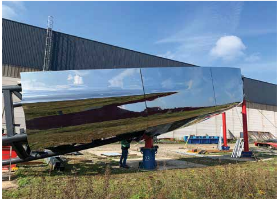
...voor validatie fabricageproces, inclusief onder andere lasvolgorde en toleranties.
