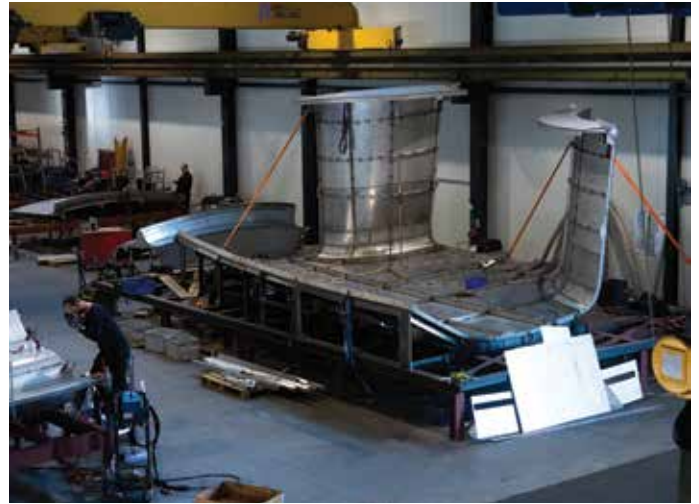
Na positionering zijn de platen onderling uitgelijnd. Daarna volgt het binnenwerk.
