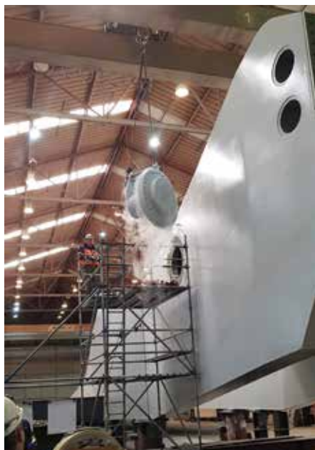
Bij opwarmen zit het lagerstoel moervast.
