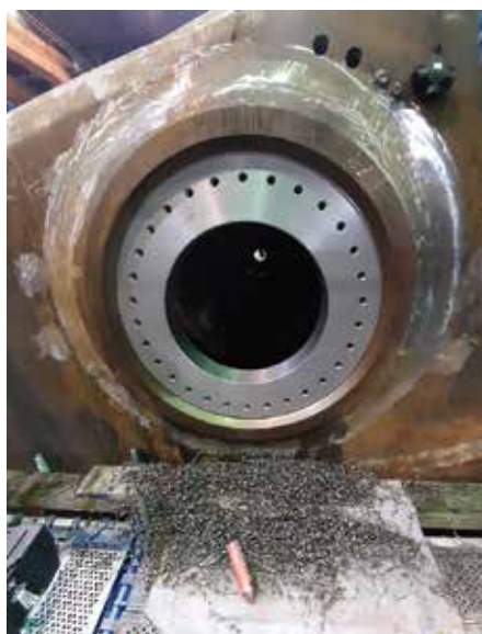
Met precisiemateriaal (beitels, frees etc.) op de juiste maat gebracht.
