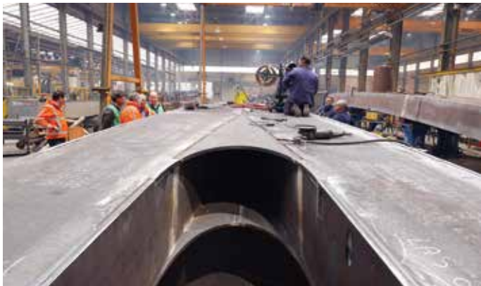
Broekstuk waarbij de boog van twee losse bogen overgaat in één boog.
