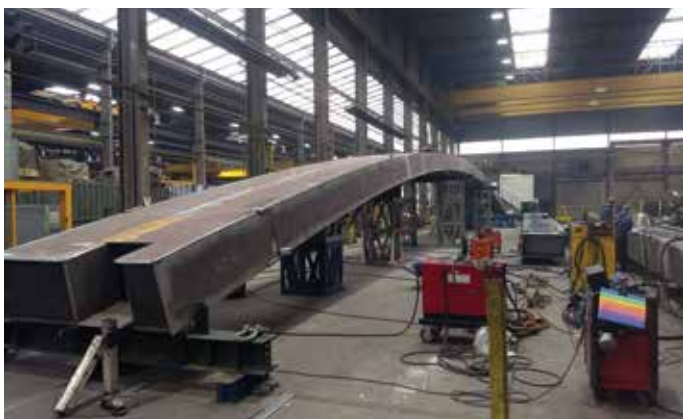
Opstelling met middenboog (drie segmenten) volledig gemonteerd.
